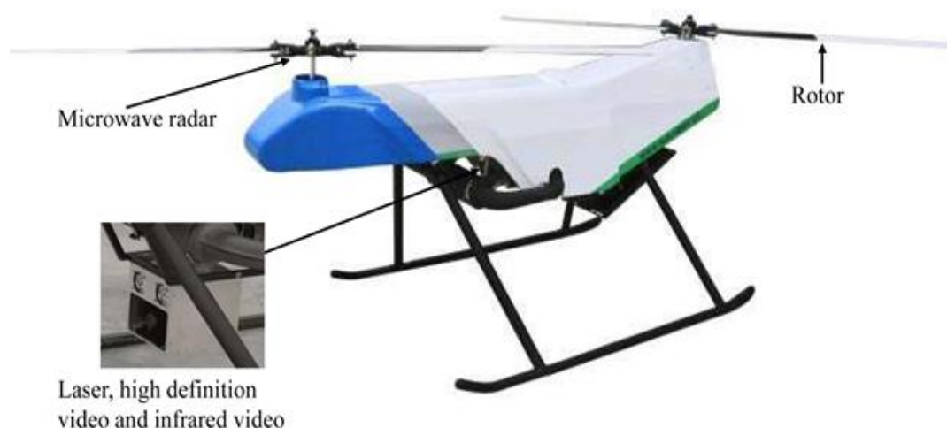
شکل ۳. پهپاد مورد استفاده در سیستم اطفای حریق LY100.
